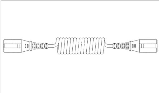
7-polige 24 V Spiralleitung (N bzw. ISO 1185), Wendeldurchmesser 35 mm mit angespritzten Steckern, Kabel 6x 1,0 mm<sup>2</sup> + 1x 1,5 mm<sup>2</sup>, Kabelmaterial: PUR
