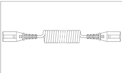
7-polige 24 V Zusatz-Spiralleitung (S bzw. ISO 3731), Wendeldurchmesser 35 mm mit angespritzten Steckern, Kabel 6x 1,0 mm<sup>2</sup> + 1x 1,5 mm<sup>2</sup>, Kabelmaterial: PUR
