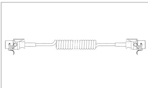
EBS/24 V-ADR Spiralleitung (ISO 7638-1), Wendeldurchmesser 50 mm mit Knickschutztüllen, Kabel 5x 1,5 mm<sup>2</sup> + 2x 4,0 mm<sup>2</sup>,
