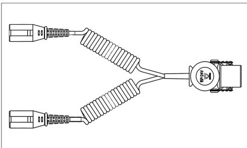
Adapterspiralleitung von 15-poliger Steckdose (ISO 12098) zu 2x 7-poligen Steckdosen (N/S bzw. ISO 1185 + ISO 3731), 7P/24 V Stecker mit angespritzten Steckern, Wendeldurchmesser 35 mm
