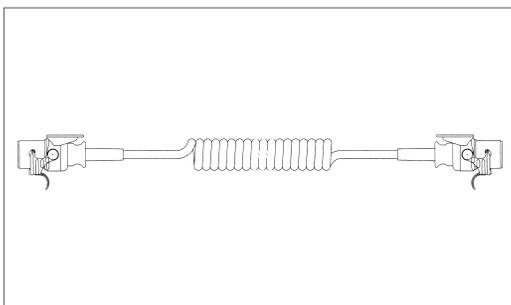
15-polige 24 V-ADR Spiralleitung (ISO 12098), Wendeldurchmesser 55 mm mit Knickschutztüllen, Kabel 12x 1,5 mm<sup>2</sup> + 3x 2,5 mm<sup>2</sup>,
