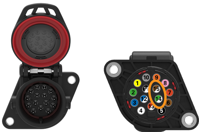
Anhängersteckdose 15-polig 24V nach ISO 12098 mit rückseitiger Belegungsanordnung und CAN-BUS. Die CAN-BUS-Datenleitungen befinden sich in den Kammern 14 und 15.
